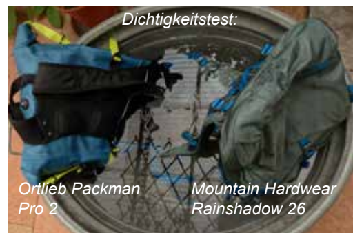
Beim Dichtigkeitstest eingedringendes Wasser im Ortlieb Packman Pro 2
